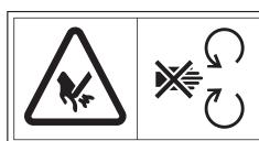
Ügyeljen a forgó késekre. A gép működése közben ne nyúljon be se kézzel, se lábbal a gép nyílásiba.
