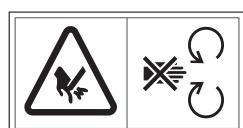
Previdno pri vrtečih se rezilih. Ko naprava deluje naj bodo roke in noge stran od odprtin.
