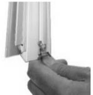
Fäst profilerna samman genom att föra de fyrkantiga bultarna in i profilens kanal och fäst dem i hålet i den motsvarande skenan. Spänne inte åt muttrarna helt innan hela ramen är i rätt ställning. **OBS: ALLA PROFILER SOM KOPPLAS BÖR FÄSTAS JÄMNT OCH SPÄNT FÖR ATT MINSKA RISKEN FÖR LÄCKAGE.**
