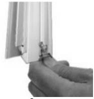
Fest profilene sammen ved å føre boltene med firkanhode inn i profilenes spor og feste dem i hullene i tilstøtende stenger. Stram ikke mutterne helt til før hele rammen er i rett vinkel. **VÆR OPPMERKSOM PÅ AT ALLE TILSTØTENDE PROFILER MÅ VÆRE I FLUKT OG SITTE TETT SAMMEN FOR Å SIKRE AT LEKKASJER HOLDES TIL ET MINIMUM.**
