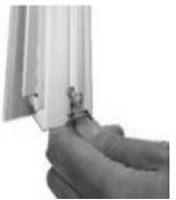
Schrauben Sie die Profile zusammen, indem Sie die Vierkantschrauben in den Profilkanal schieben und am Loch im entsprechenden Balken befestigen. Ziehen Sie die Muttern erst dann fest, wenn der Rahmen vollkommen rechtwinklig ist. **ALLE ANSCHLUSSPROFILE MÜSSEN BÜNDIG UND FEST VERBUNDEN SEIN, UM UNDICHTIGKEITEN AUF EIN MINIMUM ZU REDUZIEREN.**
